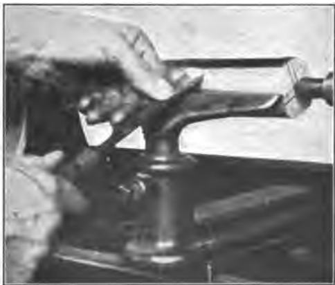
Fig. 13. Using Roughing Gouge.
